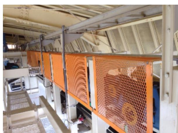
また、中長期整備計画を策定し、索道設備の永続的な維持管理及び自動循環式索道場内装置の回転部に保護カバーを設置し、スタッフの安全確保に努めています。
